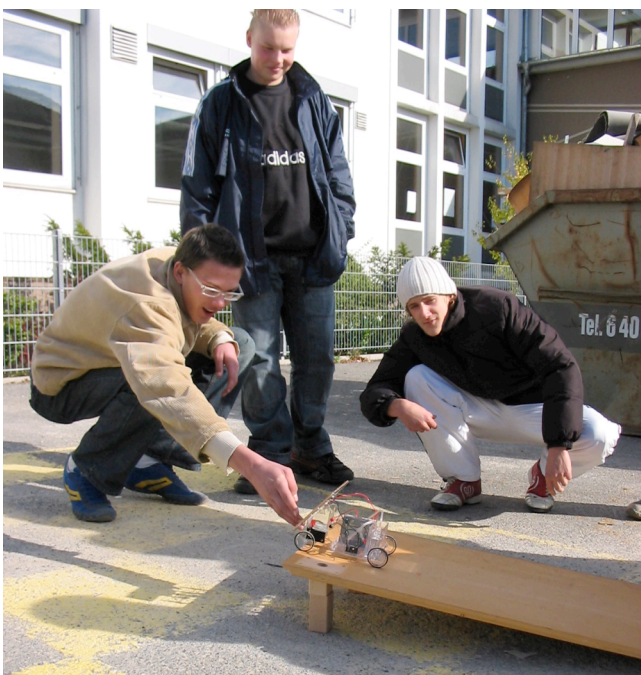
Abb. 5.5: Versuche zur Bestimmung der „Kletterfähigkeit“ der Solar-Autos. Die Schüler variieren die Neigung der Rampe mit Holzklötzen.
