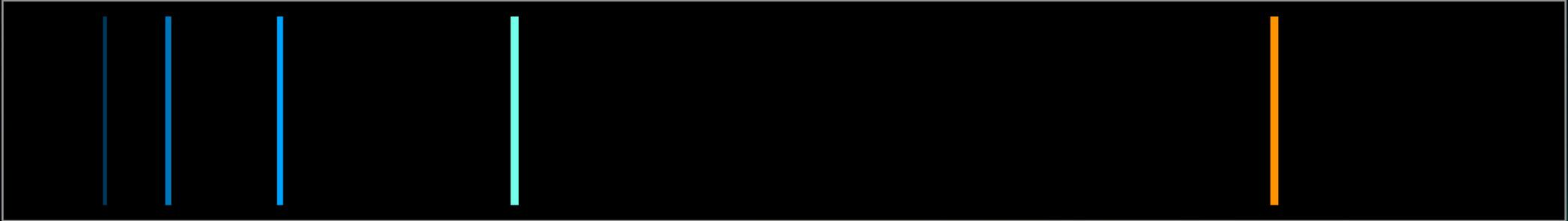
**Das Licht einer Wasserstoff-Flamme wird durch ein Prisma in einzelne Spektrallinien zerlegt.**
