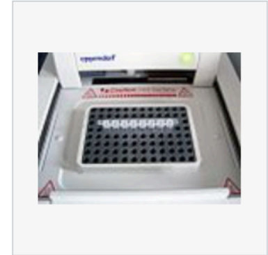
geöffneter Thermocycler, Heizblock mit acht PCR-Reaktionsgefäßen
